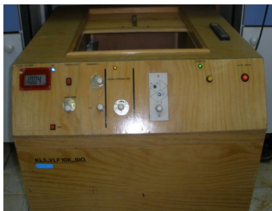
شکل ۱- دستگاه تولیدکننده میدان الکترومغناطیسی با سیستم تنظیم فرکانس و نمایش فرکانس به صورت دیجیتالی با دقت ۰/۰۰۱ هرتز. محل قرارگیری نمونه در درون محفظه است.
